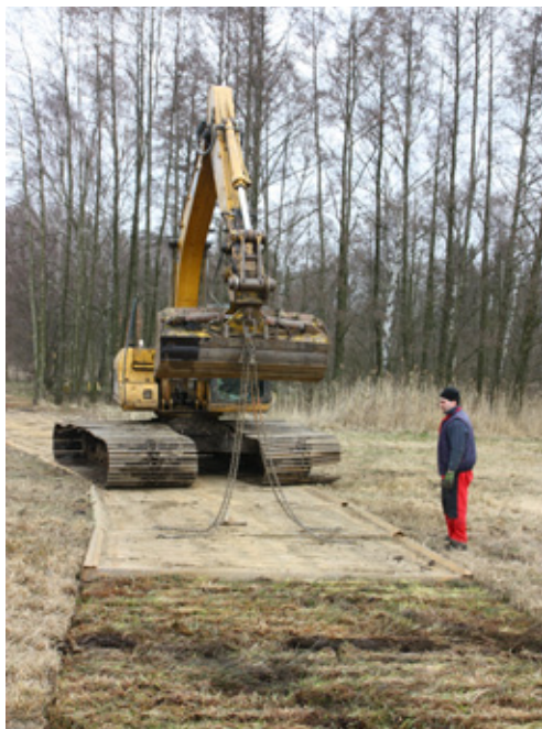
Na přesuny těžké techniky přes cenné luční biotopy se osvědčily kovové mobilní vozovky. Foto: Vlastimil Peřina
